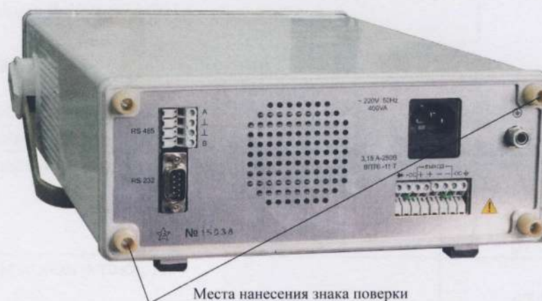
Рисунок 2 - Схема пломбировки от несанкционированного доступа и места нанесения знака поверки
