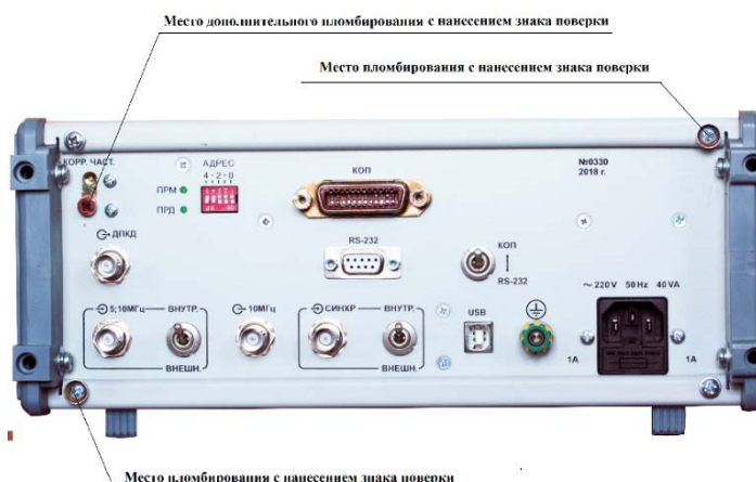
Рисунок 2 - Схема пломбировки от несанкционированного доступа, обозначение мест нанесения знака поверки
