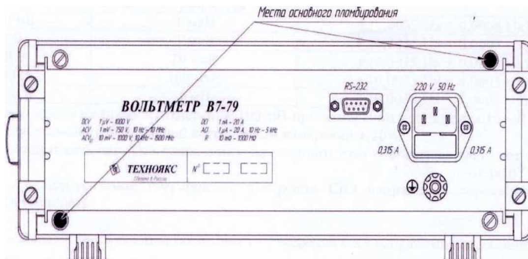
Рисунок 2 - Схема пломбировки от несанкционированного доступа
