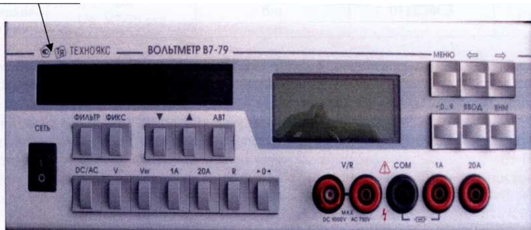
Рисунок 1 - Внешний вид вольтметра универсального В7-79
